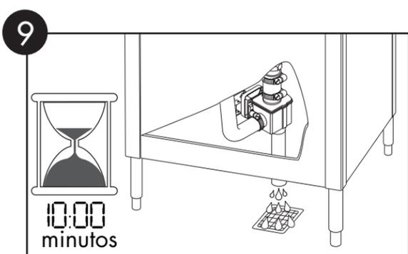
9 Se mantiene abierta la válvula de drenaje automático eléctrico durante 10 minutos y luego se cierra automáticamente.\*\*
