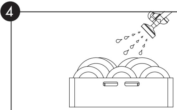
4 Raspe previamente y cargue los utensilios en la rejilla. Inserte la rejilla en la máquina y cierre las puertas.\*
