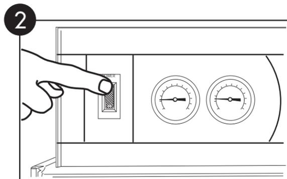
2 Ponga el interruptor de encendido/apagado en la posición encendida. El interruptor se iluminará y la máquina se llenará de agua.
