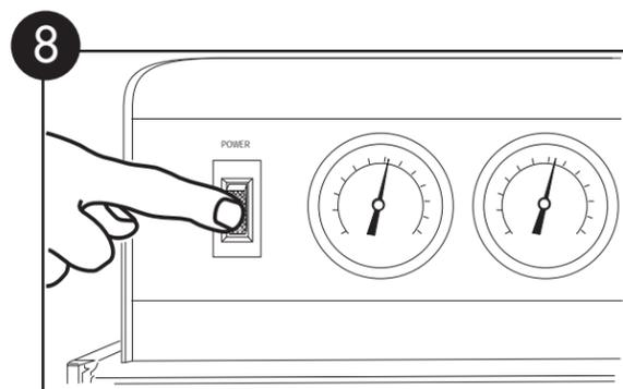
8 Ponga el interruptor de encendido/apagado en la posición apagada. El interruptor se apagará y la máquina empezará a drenar.
