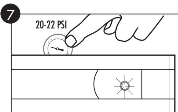
7 Revise el medidor de presión del enjuague final durante el enjuague final. El medidor debe indicar 20-22 PSI.
