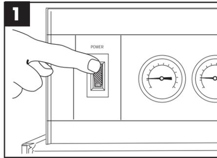
1 Ponga el interruptor de encendido/apagado en la posición apagada. La máquina se drenará automáticamente.
