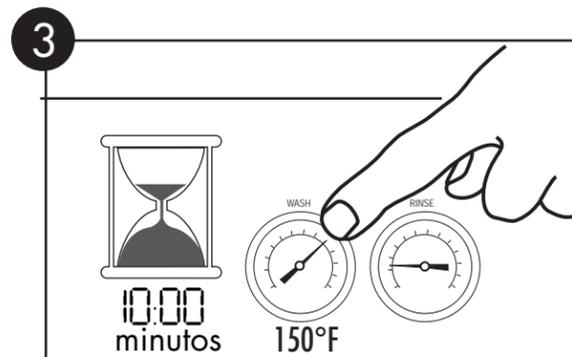
3 Espere 10 minutos para que el medidor de temperatura indique 150°F/66°C.
