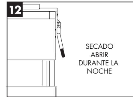
12 Vuelva a armar la máquina y deje abierta la tapa para ayudar a secar durante la noche.
